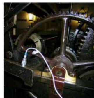
Akzelerometer am Uhrwerk des Big Ben
